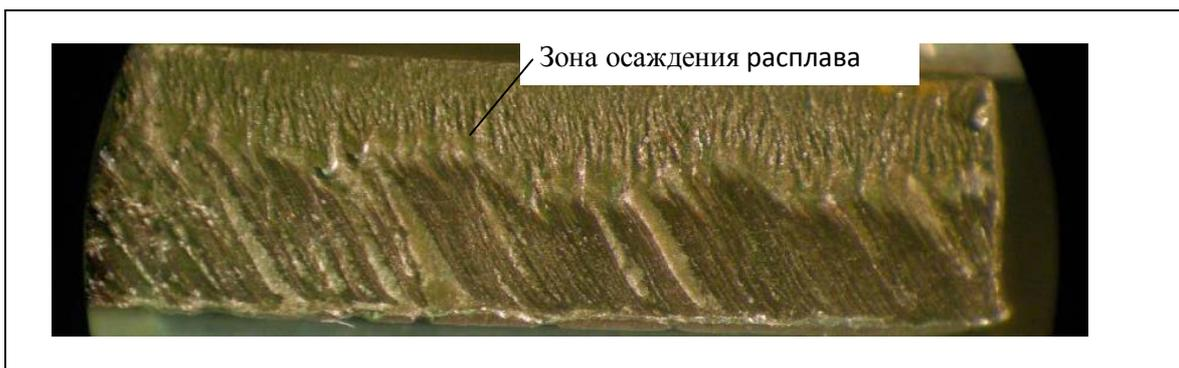
Рисунок 3 - Увеличение зоны осаждения расплава на поверхности реза стали 12X18Н10Т после тонкоструйной плазменной резки при уменьшении тока и скорости обработки ( $I = 26\text{ A}$ ,  $V = 0,9\text{ м/мин}$ )
