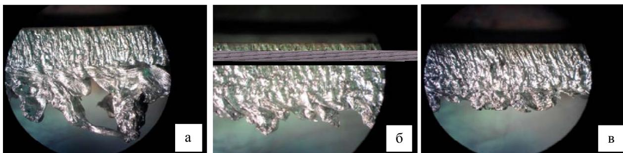
Рисунок 3 - Формирование грата на нижней кромке реза алюминия А5М при обработке на скоростях: а –  $V = 1,0$  м/мин; б -  $V = 1,2$  м/мин; в -  $V = 1,4$  м/мин
