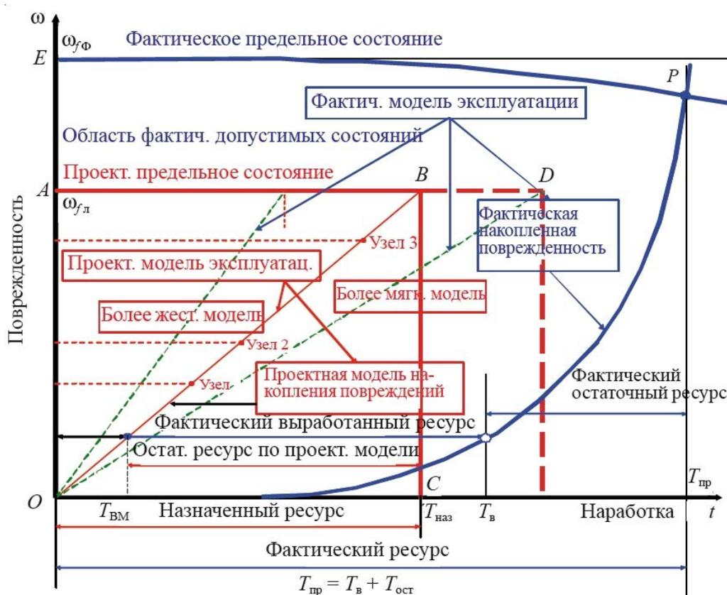
Рисунок 2 - Концепция оценки остаточного ресурса оборудования и систем ядерных энергетических установок
