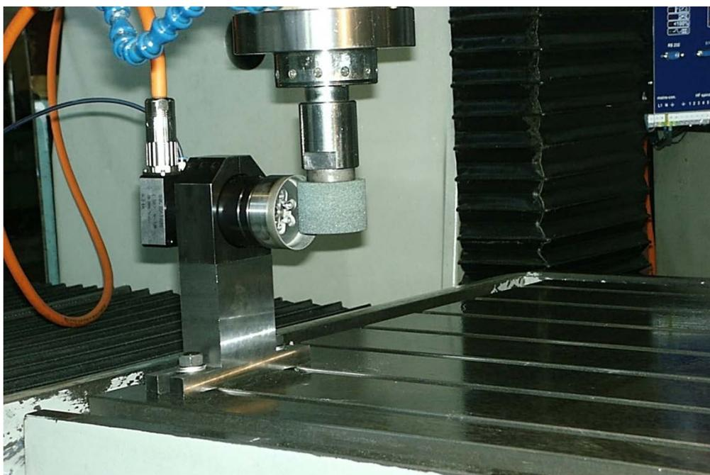
Рисунок 2 - Установка правящего шпинделя на рабочем столе станка
