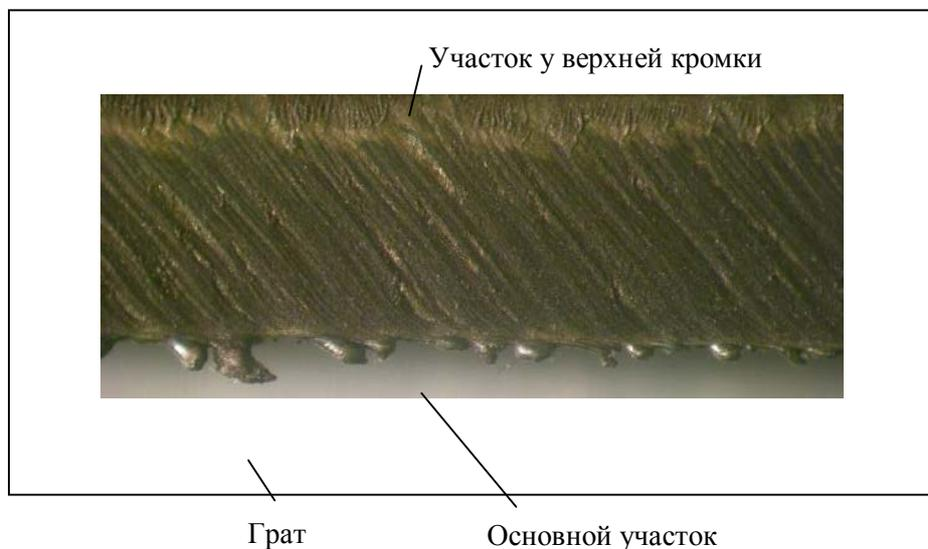
Рисунок 2 - Внешний вид поверхности реза стали 12X18Н10Т после тонкоструйной плазменной резки ( $I = 30\text{A}$ ,  $V = 1,3\text{ м/мин}$ )
