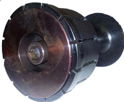
Рисунок 2 - Внешний вид разжимной цанги
